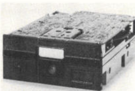
Afb. 10. Mini floppy disk K5600.10 voor 5 1/4 inch diskettes met een capaciteit van 125 Kbyte (FM) of 250 Kbyte (MFM).
