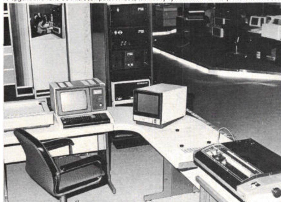
Afb. 2. Een systeem voor de dosering van de bestraling van kankerpatiënten. Deze dopsy-r is opgebouwd rond de microcomputer K1630, waarschijnlijk voorzien van de processor U 830D.
