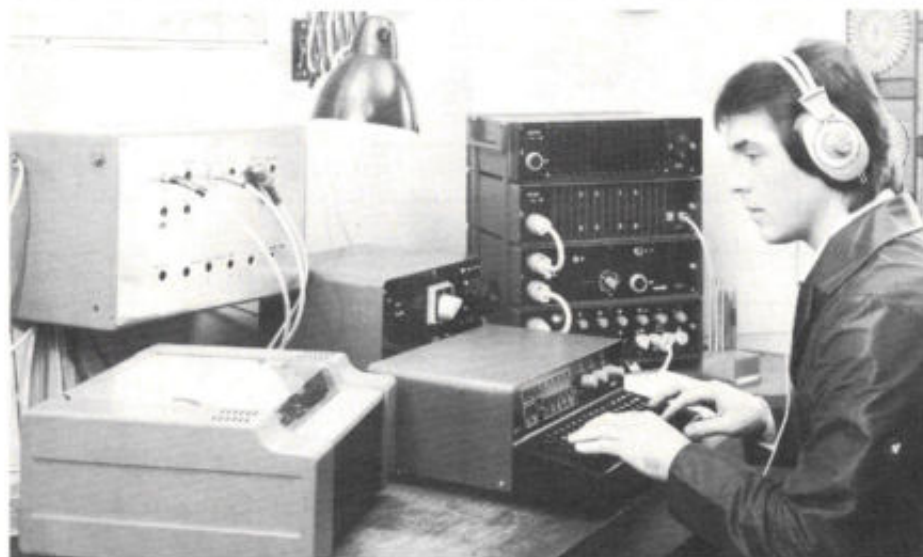
Afb. 3. Een wel heel bijzondere opname: De K1520 microcomputer wordt ook gebruikt voor mobiele installaties, die onder zeer slechte bedrijfsomstandigheden moeten werken. In dit geval een automatische morsegever MGS80 van RFT Nachrichtenelektronik, die kan werken in een temperatuurbereik van -25...+50^{\circ}\text{C} en dient voor de instandhouding van het berichtenverkeer bij uitvallen van andere verbindingsmogelijkheden. Het apparaat werkt als een telex, maar gebruikt de ouderwetse telegraafprocedures.
